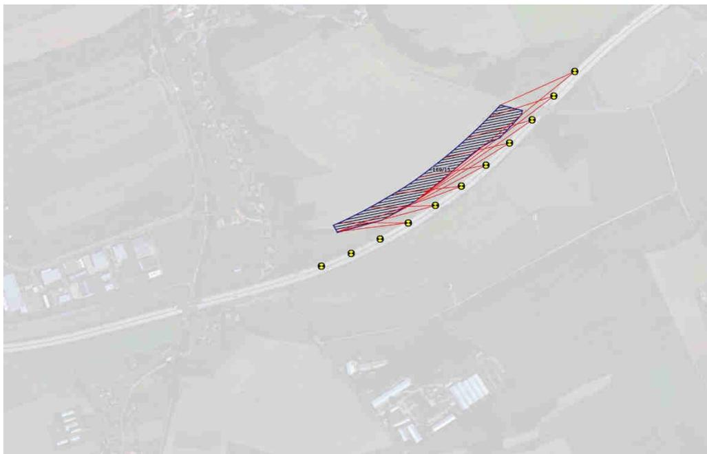
Durch die Ausrichtung der Module auf  $169^\circ$  Süd bei  $15^\circ$  Aufneigung treten in dieser Situation in Richtung der vermerkten Beobachter nur am äußeren rechten Sichtfeldrand Reflexionen bei tief stehender Sonne auf.
